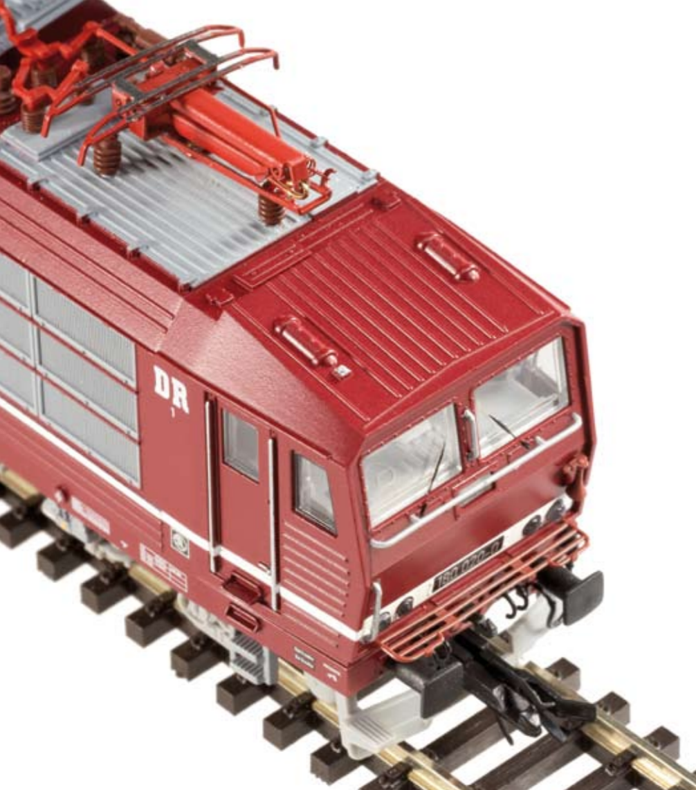
STETS GRIFFBEREIT: Die Griffstangen an der Lokfront sind freistehend ausgeführt, der Tritt ist durchbrochen.
